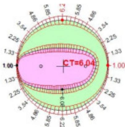
Le principe du calcul d'un précalibré consiste à calculer l'épaisseur tout autour du calibre de la monture, rechercher l'épaisseur au bord le plus mince puis à réduire l'épaisseur au centre pour obtenir l'épaisseur demandée au bord le plus mince.
