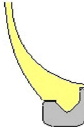
Ce problème vient du fait que l'on glante le verre à plat sur l'appareil mais une fois monté dans la monture, le verre se retrouve très incliné, ce qui déplace le point de montage initial (voir dessin ci-contre).
